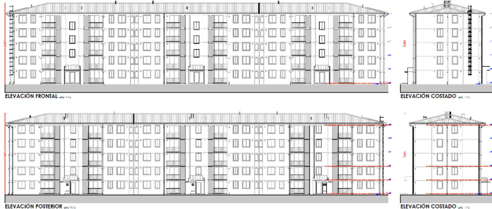
Plano elevaciones edificio tipo A se observan 5 pisos
